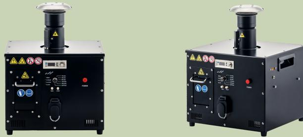
XTIE BIOPARTICLES는 코로나 방전을 이용하여 공기 중에 부유하는 세균과 바이러스를 높은 효율로 수집하고 농축하는 부유미생물 수집 장치입니다. 정전기적 인력을 사용하여 0.1 $\mu$ m 크기의 입자에 대하여 95%이상의 높은 수집효율을 나타냅니다.
